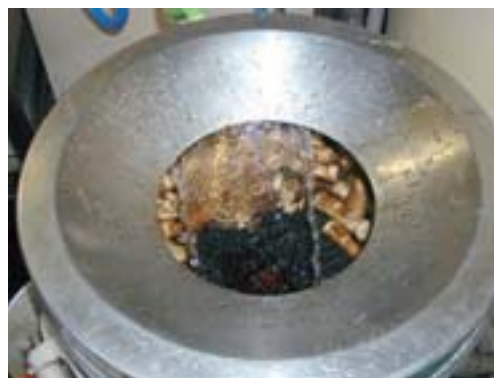
〈悪い例：蓋がないため周囲に洗浄水が飛散している〉
