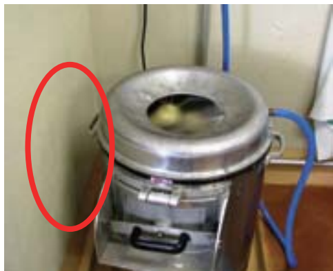
〈悪い例：蓋がないため周囲に洗浄水が飛散している〉
