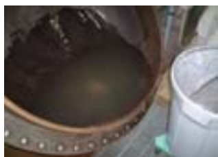
⑤ 水を流す時は、釜をゆっくり傾ける
