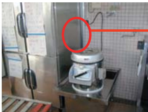
〈悪い例：球根皮むき機洗浄水による汚染〉
