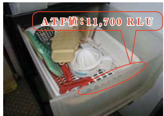
汚れが付いていた調理器具入れの引き出しの取っ手
